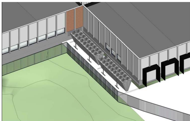
Nyløsning med to tørrkjølere ved fasade akse F/8-10
