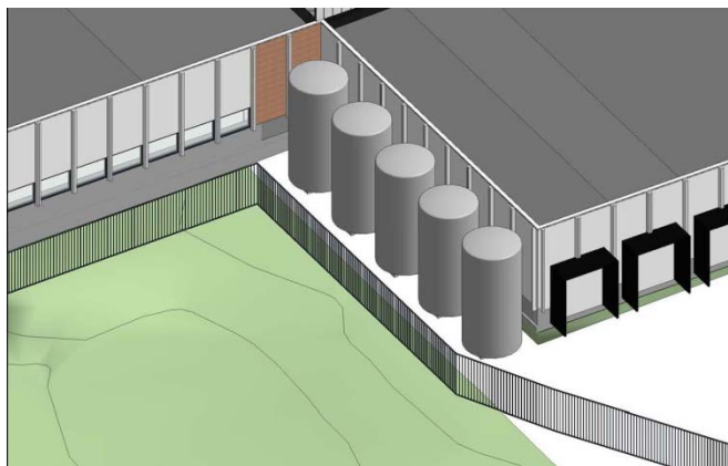
Godkjent løsning med f5 vanntanker ved fasade akse F/8-10
